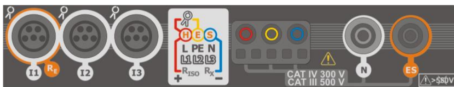
Rys. 5.1 Wejścia pomiarowe
